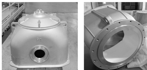
(a) 未改进储油柜 (b) 改进后储油柜
