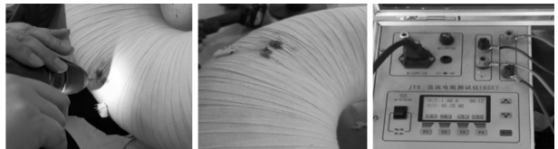
(a) 包扎完成一次绕组打孔 (b) 放入钢钉 (c) 直阻测试 图 17 油浸正立式电流互感器内部电弧故障试验引弧 Fig. 17 Arc ignition of internal arc fault test of oil-immersed upright type current transformer
